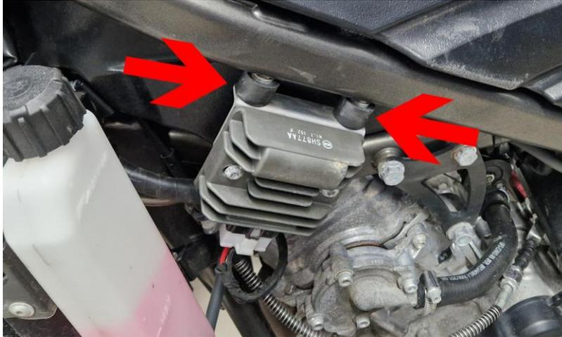
Für den Fall, dass Sie das Steuergerät tauschen, da bei Ihnen der Fehler „defekte Sicherung der Einspritzanlage“ vorliegt: Es **muss** zwingend überprüft werden, ob diese beiden Gummidämpfer zwischen Rahmen und Spannungsreglerhalteplatte verbaut sind (Bild oben).
